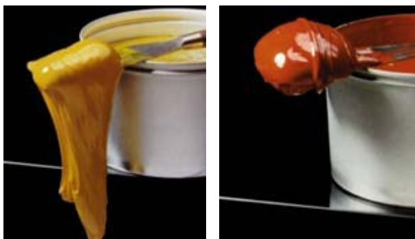
Проверка консистенции краски
