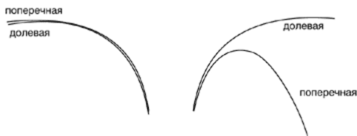
Определение долевого направления бумаги
